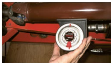
شکل ۱۳-۳- روش استفاده از زاویه سنج میل گاردان
