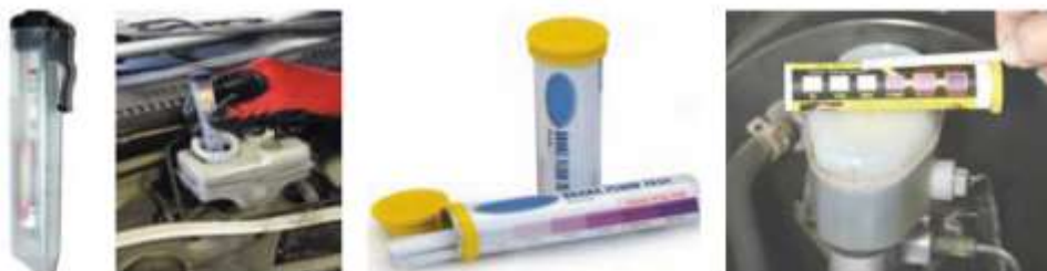
شکل ۶-۶- آزمایش کیفیت مایع هیدرولیک ترمز
