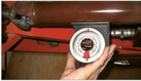
شکل ۱۳-۳. روش استفاده از زاویه‌سنج میل گاردان
