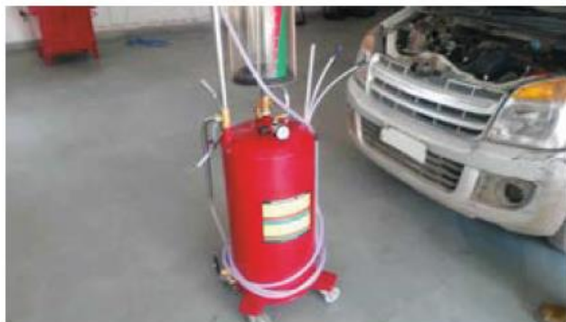
عوض کردن روغن موتور با ساکشن
